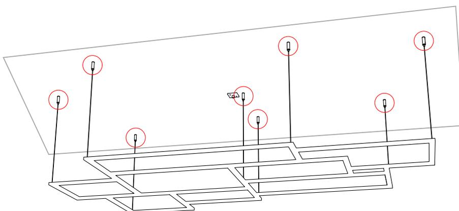
Passo 5: Após a luminária fixada no teto, conforme a ilustração, faça a instalação do driver como no manual abaixo. Logo após, regule a altura de acordo com o gosto do cliente.
